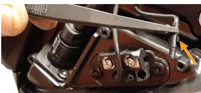
Il connettore del sensore di velocità si differenzia dagli altri per la presenza di due piccole "alette" laterali. CONTROLLARE PER EVITARE ERRORE!!!
