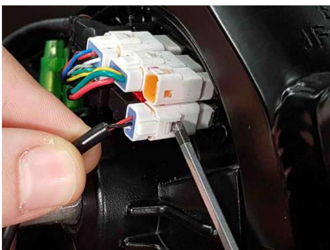
Scollegare il connettore del sensore di velocità premendo sulla linguetta.
