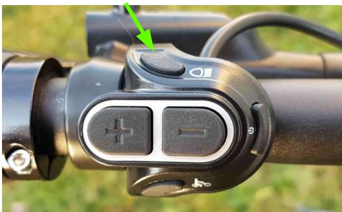
**Lo sblocco di velocità si ottiene con una rapida pressione del tasto Luce.**
