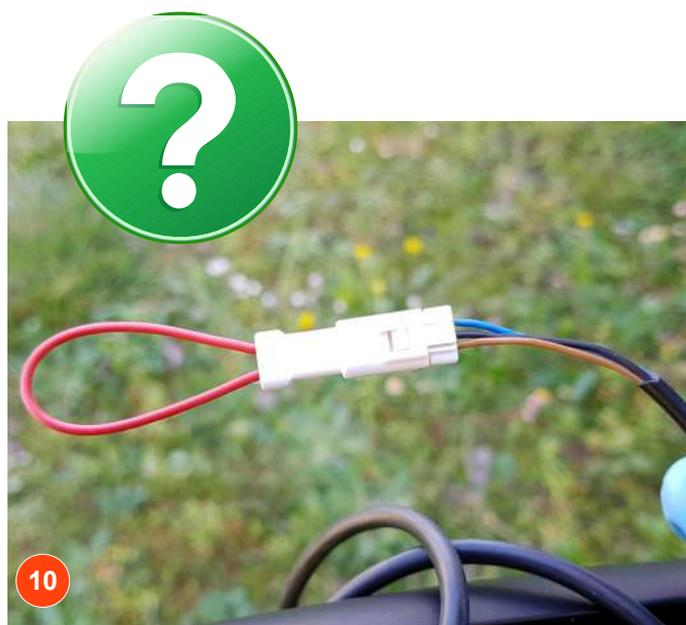
Il connettore con filo ROSSO "a ponte" va collegato al connettore alto del cablaggio quando si rimuove Ribelle.
