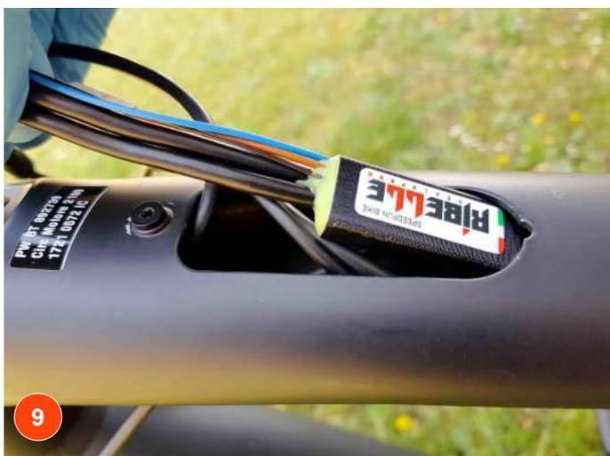
Inserire il corpo del dispositivo e i connettori all'interno del telaio.
